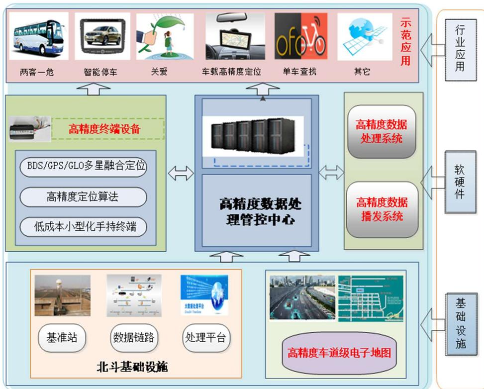
图 1 北斗亚米级高精度服务系统整体架构
