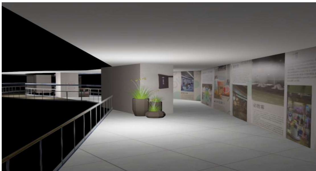
图 5：室内建模案例，采用激光设站进行 360°全方位扫描采集，采用单反相机进行高清照片拍摄工作
