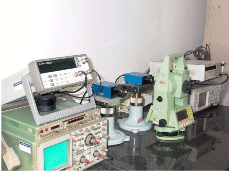
全站仪（测距仪）频率自动化检测系统
