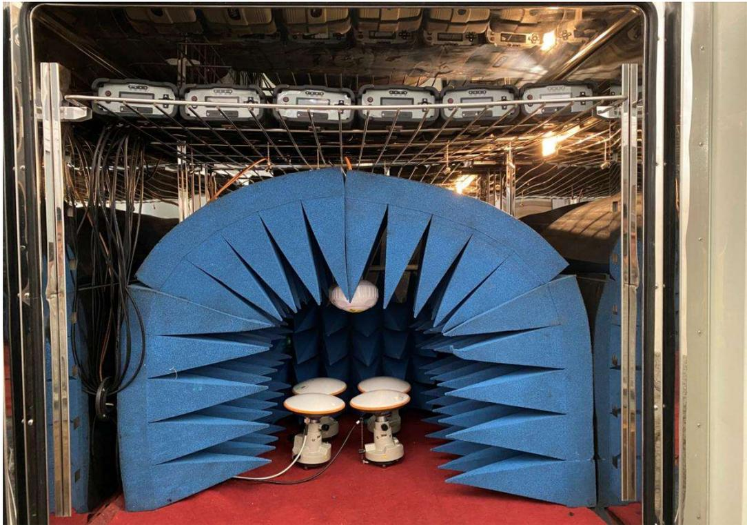
图 2 2020 珠峰高程测量仪器选型之低温试验
