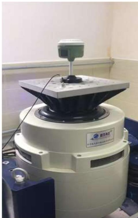
图 2 振动试验台
